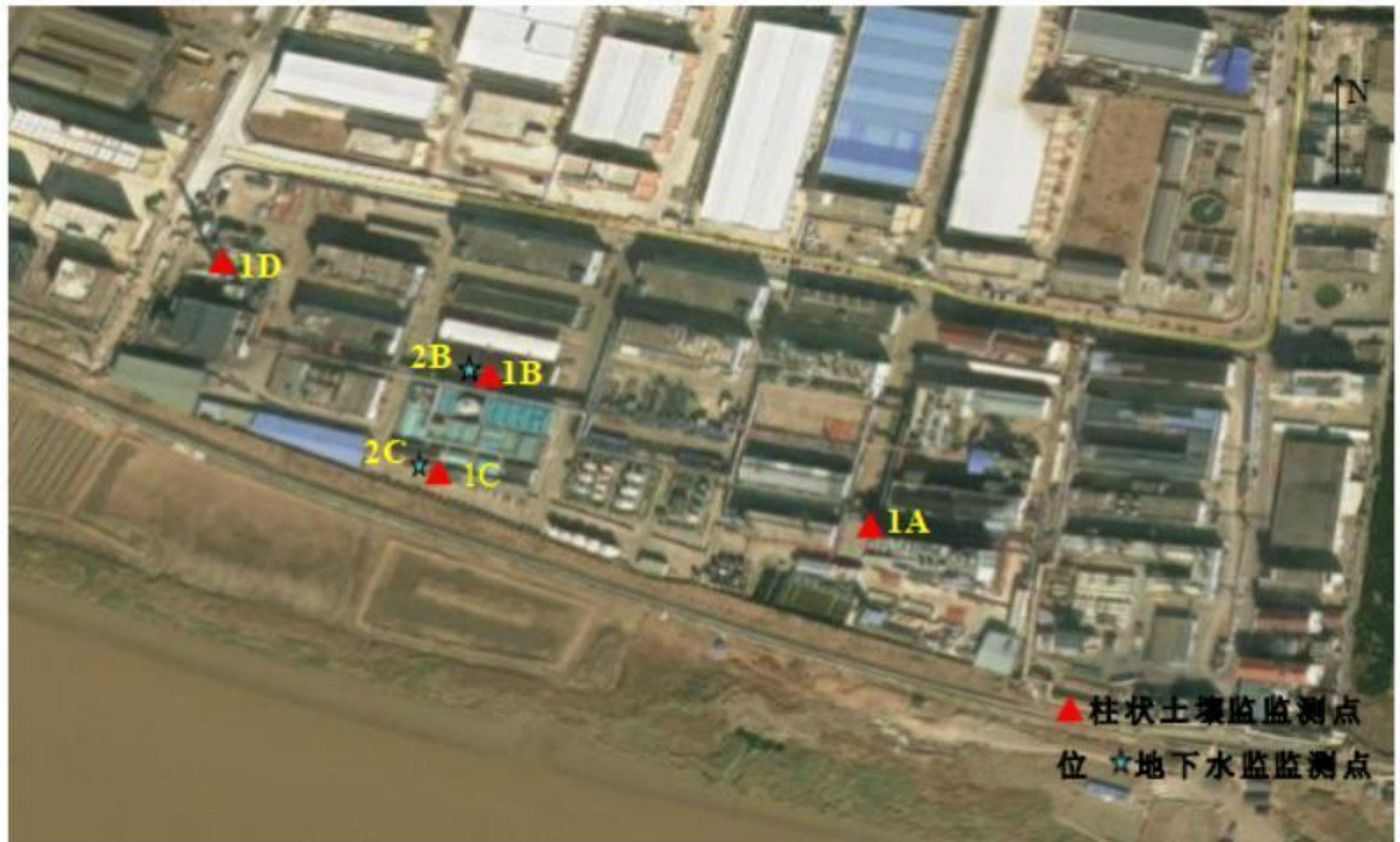
附图6 厂区土壤、地下水监测布点图
